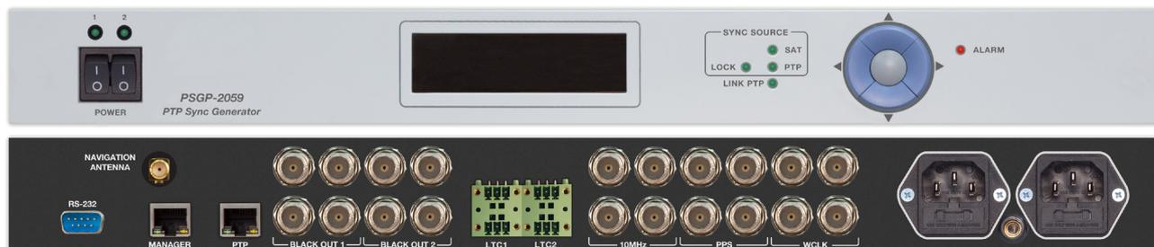
Устройство формирует **опорные сигналы** черного поля, HD tri-level, 10 МГц, PPS, Wordclock и LTC. Также формируются сигналы **синхронизации времени** NTP и PTP 1588.
