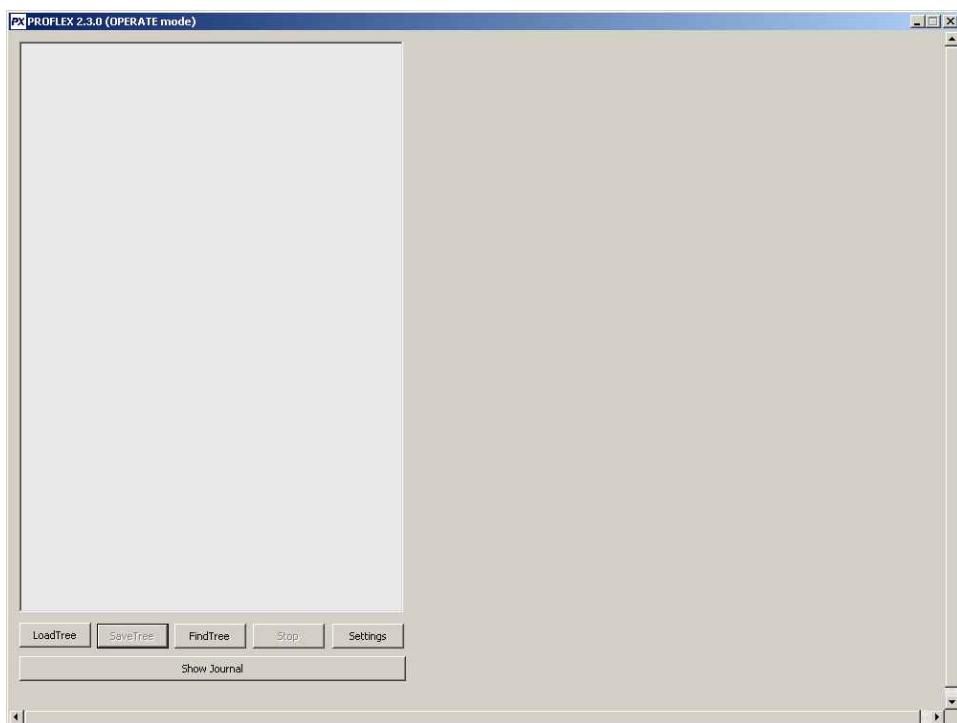
В левой части окна находится панель, в которой отображается информация о присутствующих в сети (или указанных) устройствах в виде дерева. Под ней находятся кнопки LoadTree, SaveTree, FindTree, Stop, Settings, которые предназначены для запуска, загрузки и сохранения дерева из/в файл, поиска устройств в сети, остановки работы программы и вызова окна настроек. В программе предусмотрены два режима работы - **Режим наблюдения и Режим управления устройствами**.
