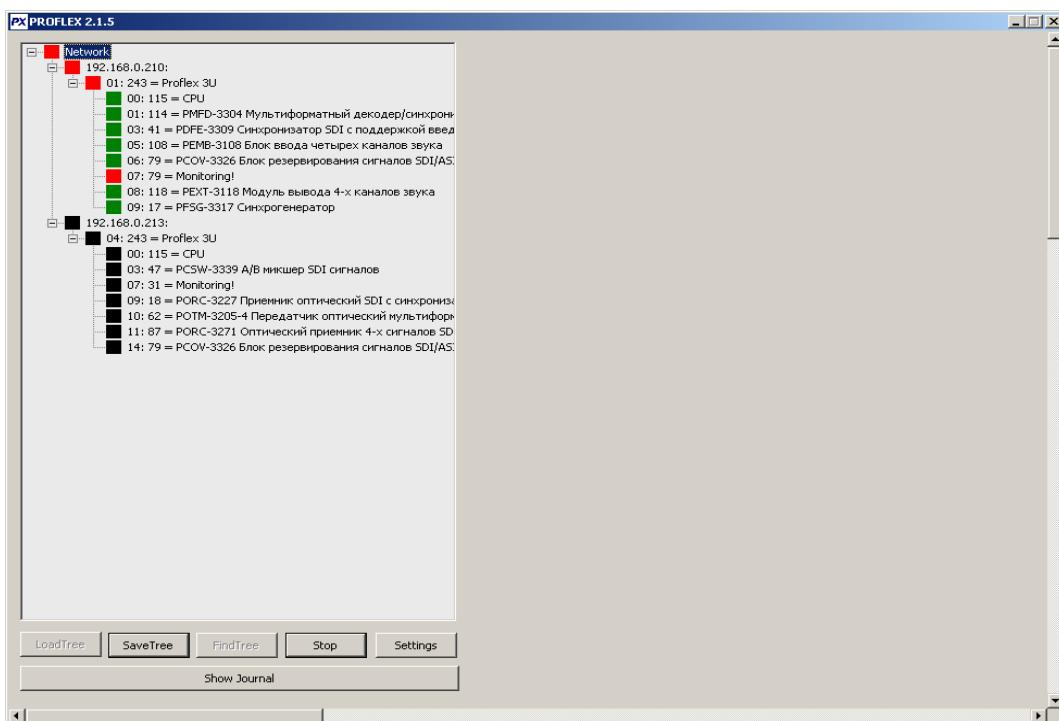
В зависимости от состояния блока на данный момент, его пиктограмма в дереве устройств будет выглядеть следующим образом:
