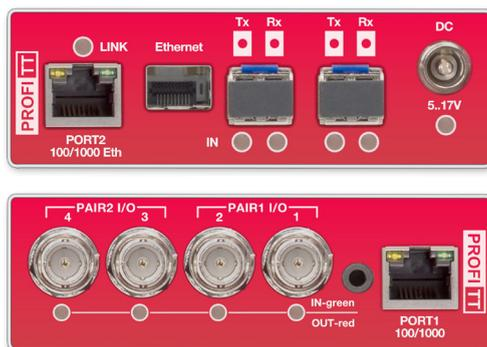
Содержит до 4-х независимых оптических конвертеров. В зависимости от устанавливаемого пользователем типа SFP происходит автоматическая конфигурация устройства как Tx, Rx или Tx+Rx. Устройство имеет опциональный Gigabit Ethernet оптический конвертер.
