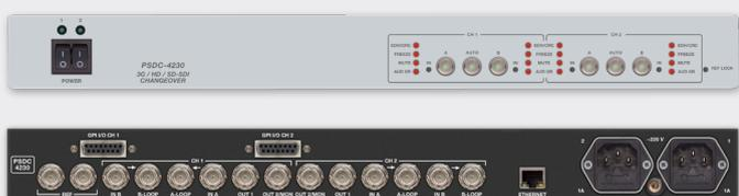
Автономный двухканальный коммутатор резерва для сигналов SDI. Автоматический выбор входа на основе мониторинга входных сигналов. Мониторинг пропадания сигнала, ошибок EDH, заморозки видео и снижения уровня звука. Два независимых коммутатора в одном корпусе.
