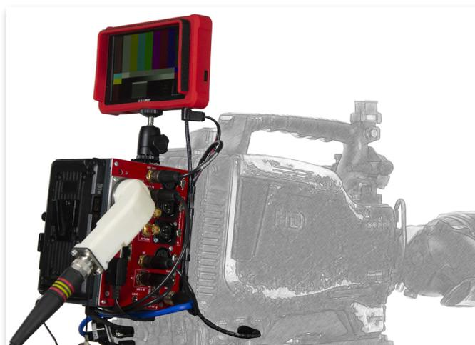
Камерный адаптер PFC-021 крепится к камере вместо внешнего аккумулятора. OLED дисплей и кнопки навигации адаптера предназначены для конфигурирования системы, подстройки уровней Intercom и других параметров.
